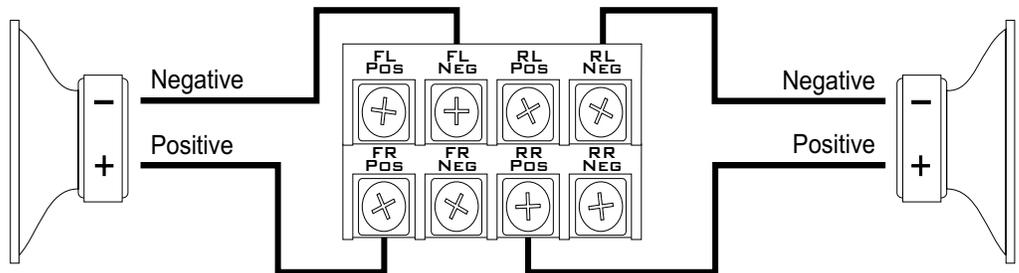
TO BRIDGE THE 4300X FOR TWO CHANNEL OPERATION USE THE RIGHT POSITIVE AND LEFT NEGATIVE OF THE FRONT AND REAR SPEAKER PAIRS
